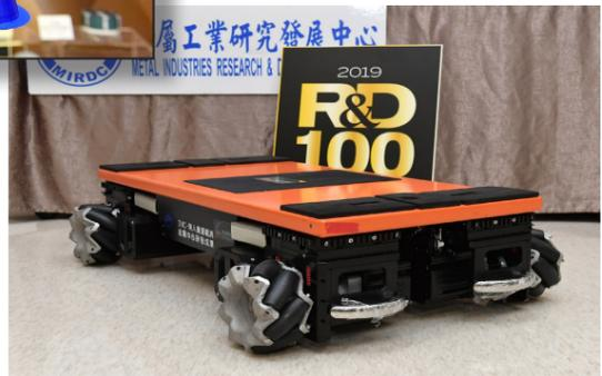
金屬中心的「協同搬運模組」，可即時同步操控數台自動導向車來執行搬運任務，實現未來智慧化的搬運模式。
